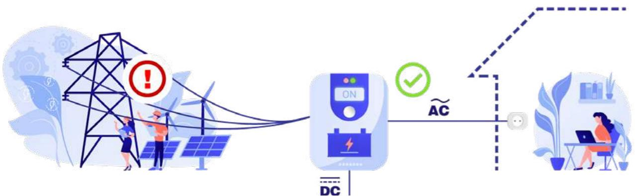
UPS uređaj koristi baterije za održavanje napajanja priključenih uređaja u slučaju nestanka ili fluktuacije struje. Da bi to učinio, pretvara istosmjernu struju (DC) koju proizvodi u izmjeničnu struju (AC) koja je kompatibilna s uobičajenim električnim i elektroničkim uređajima.
